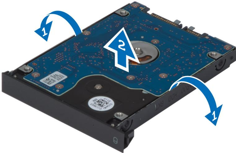
**メモ:** ハードドライブブラケットには、7 mm ハードドライブ用のゴム製フィラーが取り付けられています。このフィラーの目的は、振動を抑えることと、7 mm ハードドライブを正しく取り付けられるようにすることです。9 mm ハードドライブをハードドライブブラケットに取り付ける場合には、このフィラーは不要です。
