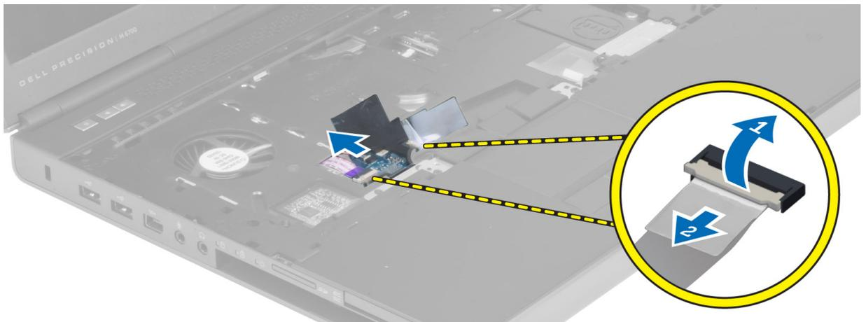
8. タッチパッドケーブルをパームレストに固定している粘着テープをはがします。
