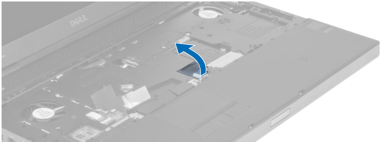
9. タッチパッドケーブルをシステム基板から外します。
