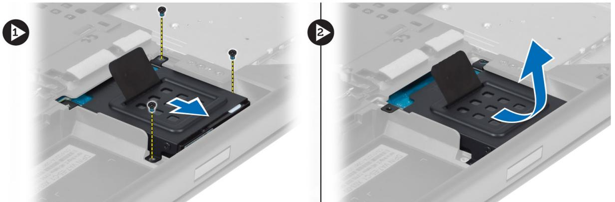
5. セカンダリハードドライブをブラケットに固定しているネジを外します。
