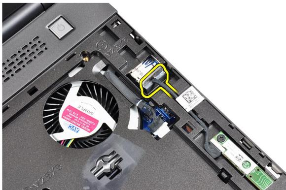
12. パームレストをコンピュータに固定しているネジを外します。
