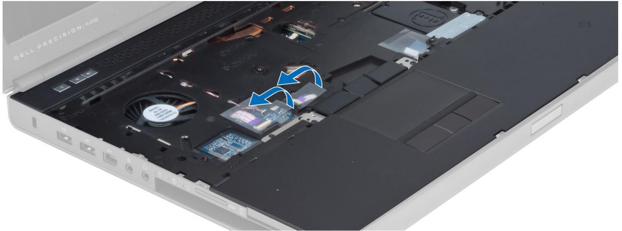
7. メディア基板ケーブルとスピーカークーブルをシステム基板から外します。
