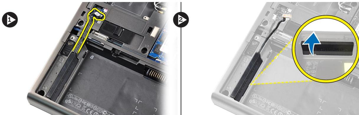
4. Bluetooth モジュールをコンピュータから取り外します。Bluetooth モジュールを固定しているネジを外します。
