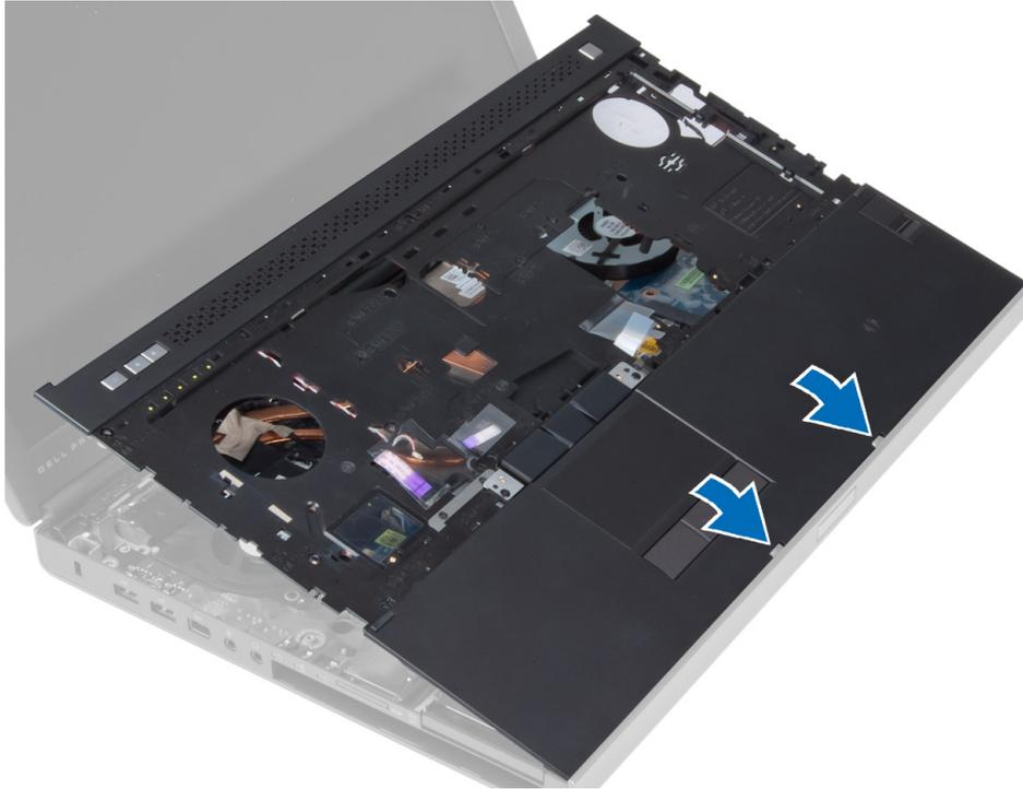
2. パームレストをコンピュータに固定するネジを締めます。
