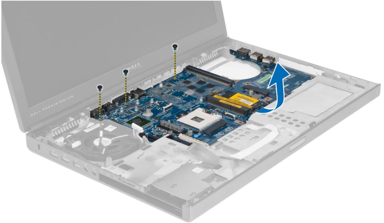
9. システム基板をコンピュータから取り外します。
