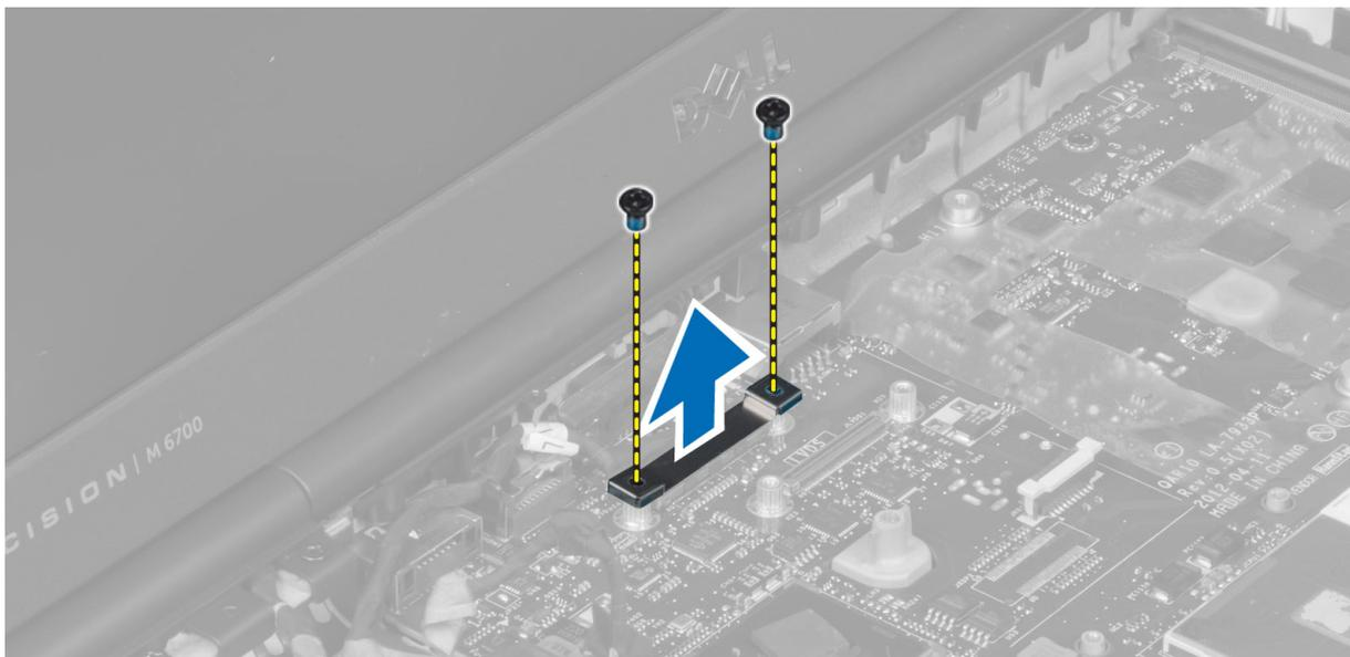
5. LVDS ケーブル、カメラケーブル、および電源コネクタケーブルを、システム基板から外します。
