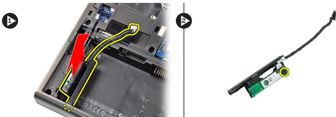
5. Bluetooth モジュールを取り外し、Bluetooth ケーブルをモジュールから外します。
