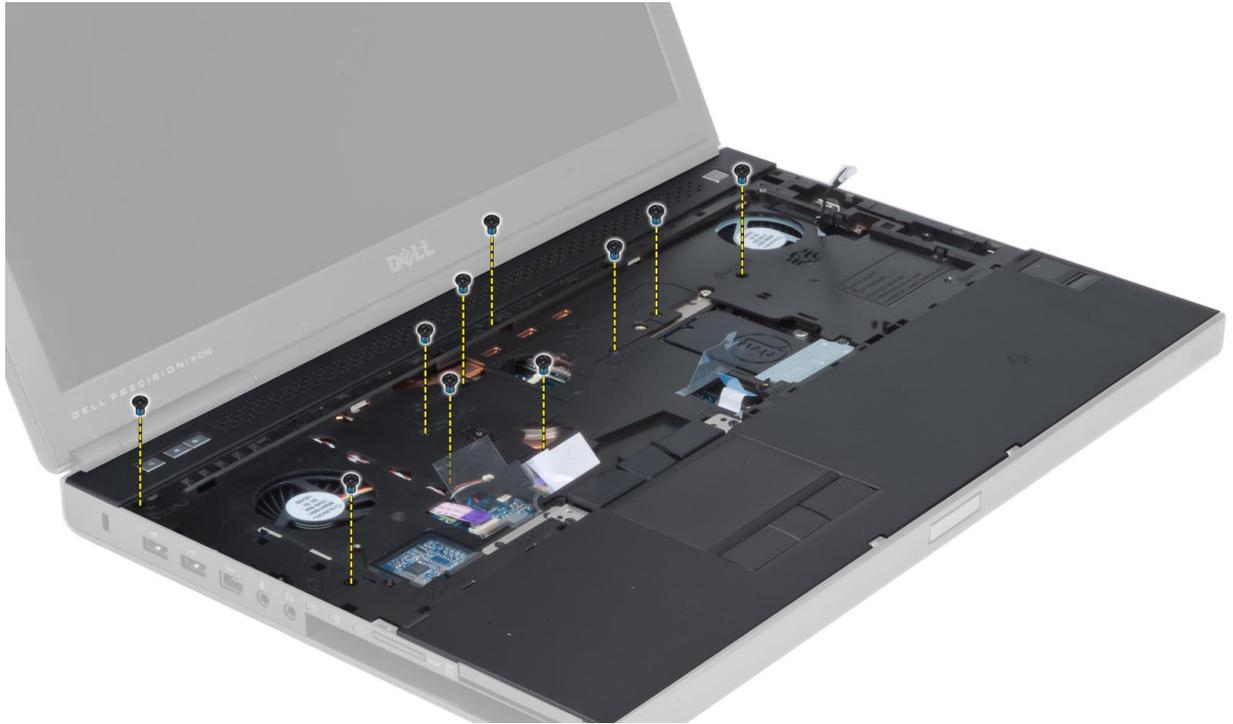
13. パームレストの左端を持ち上げます。パームレストの右端にあるタブを外して、パームレストをコンピュータから取り外します。
