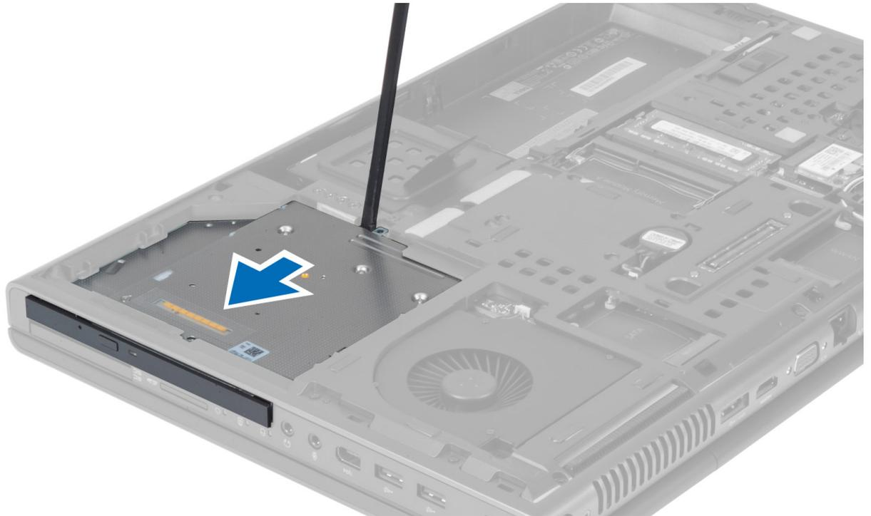
5. ドライブラッチブラケットを光学ドライブに固定しているネジを外し、ブラケットを外します。
