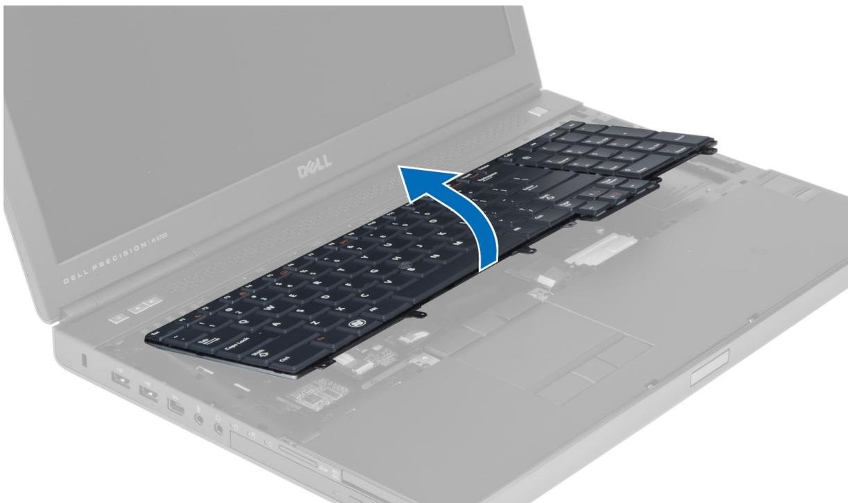
5. キーボードデータケーブルをシステム基板から外して、キーボードを外します。
