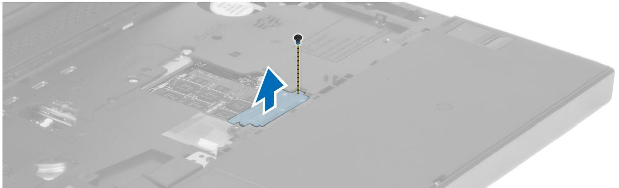
4. メモリモジュールがポンと飛び出すまで、保持クリップを開きます。メモリモジュールを持ち上げて、コンピュータから取り外します。
