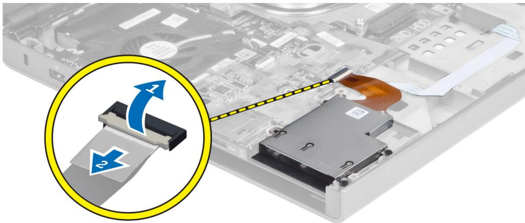
4. ExpressCard モジュールをコンピュータに固定しているネジを外し、ExpressCard モジュールを取り外します。
