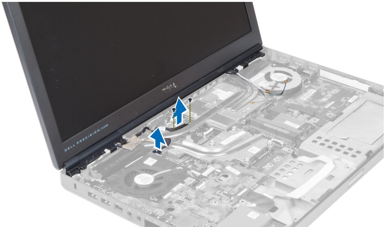
7. ディスプレイアセンブリをコンピュータに固定しているネジを外し、コンピュータから取り外します。
