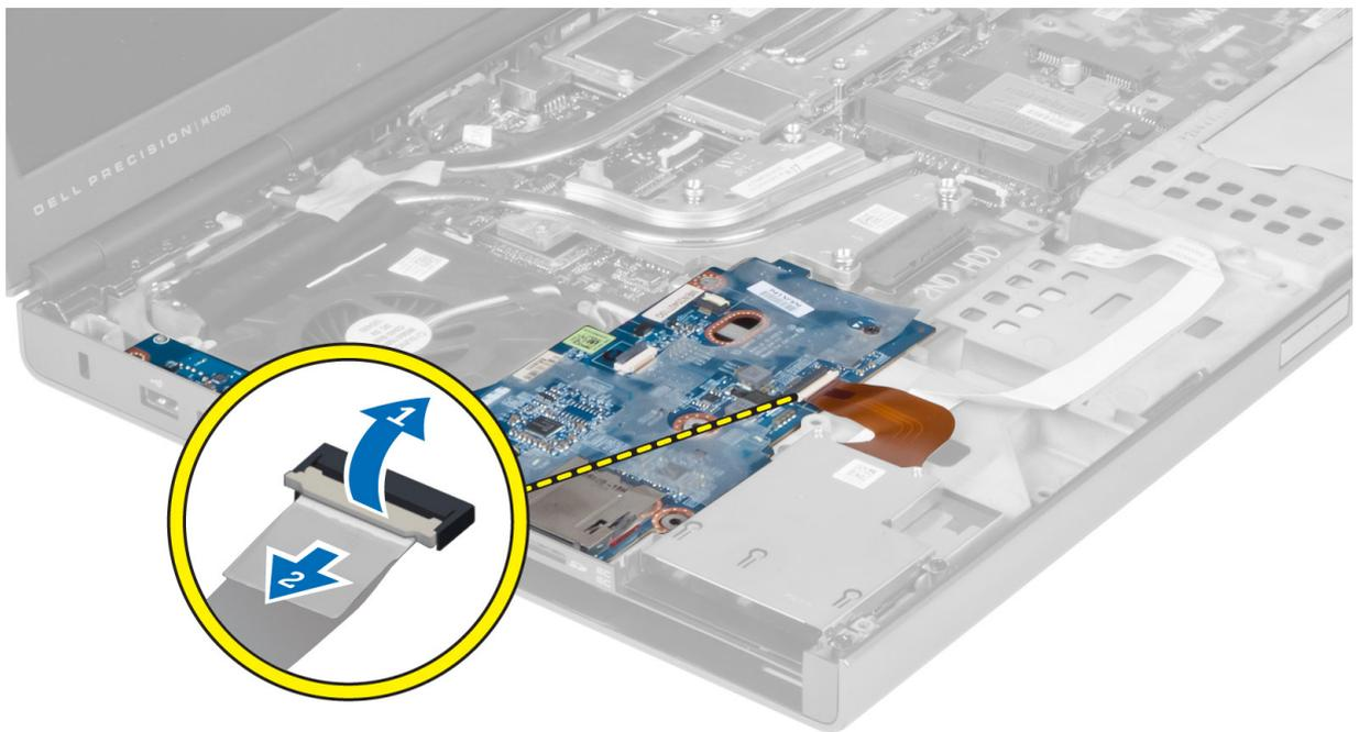
4. I/O ボードをコンピュータに固定しているネジを外します。I/O ボードの右端を持ち上げてコネクタを外し、I/O ボードをコンピュータから取り外します。
