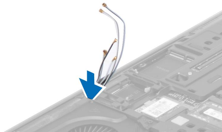
4. コンピュータを裏返して、配線用の穴からアンテナケーブルを引き出します。
