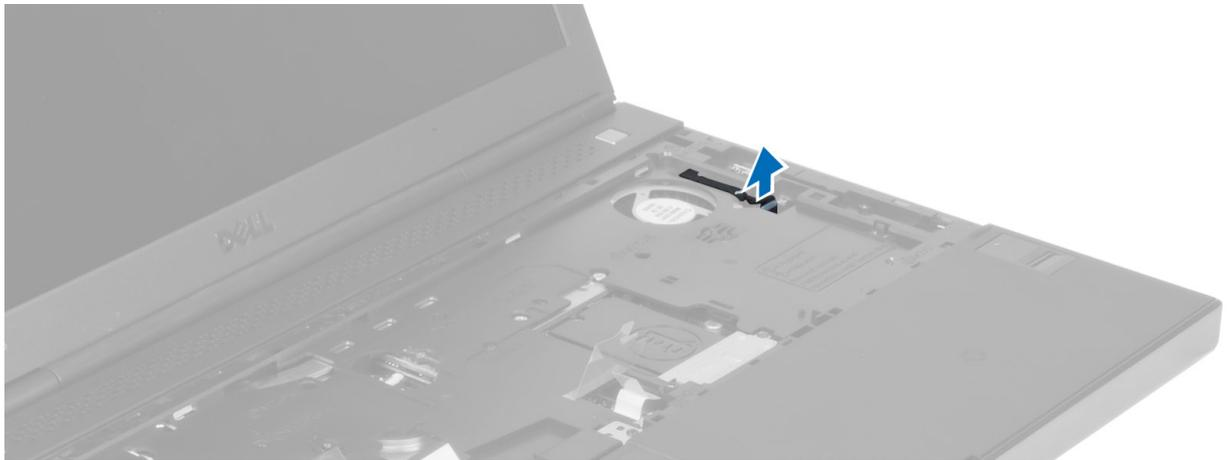
11. Bluetooth モジュールケーブルをシステム基板から外します。
